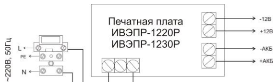
Схема подключения «ИВЭПР – 1230PM-7», «ИВЭПР – 1220PM-7»
