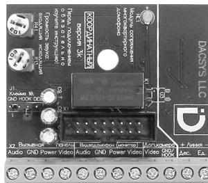
При регулировке **не используйте усилие**, винт регулятора должен вращаться легко на угол около 300°. Для вращения рекомендуется использовать небольшую отвертку. После настройки уровней соберите модуль обратно и уберите в предназначено для него место.
