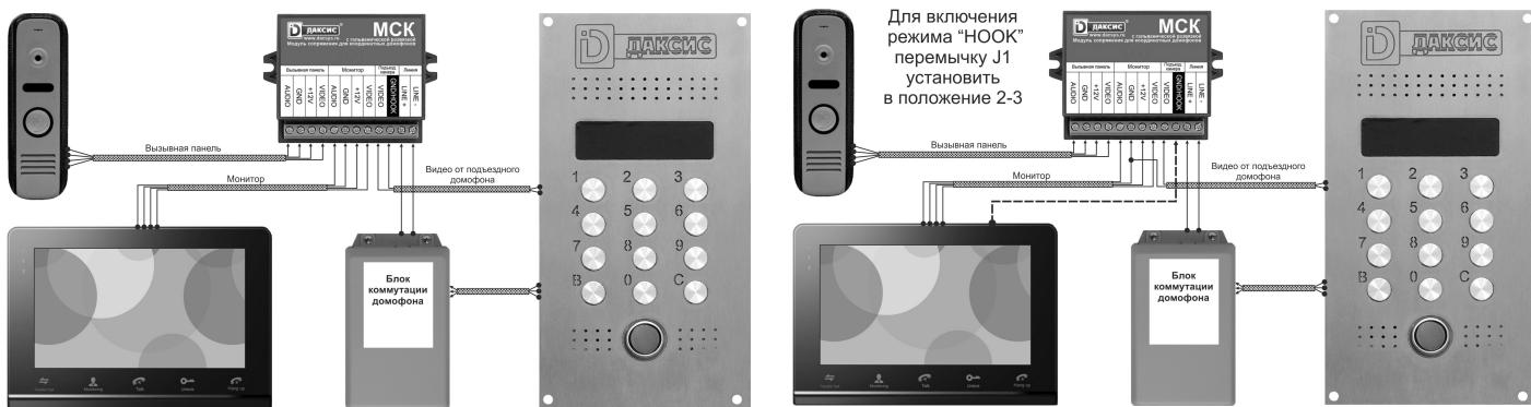
При подключении по правой схеме не забудьте перевести перемычку J1 в положение 2-3, при этом назначение клеммы 10 переключится из GND во вход сигнала HOOK. Общий провод сигнального кабеля подъездного видео нужно подключать к любой другой клемме GND (2 или 6) в такой конфигурации. **Если Ваш видеодомофон не оборудован выходом сигнала HOOK - не переставляйте эту перемычку.**
